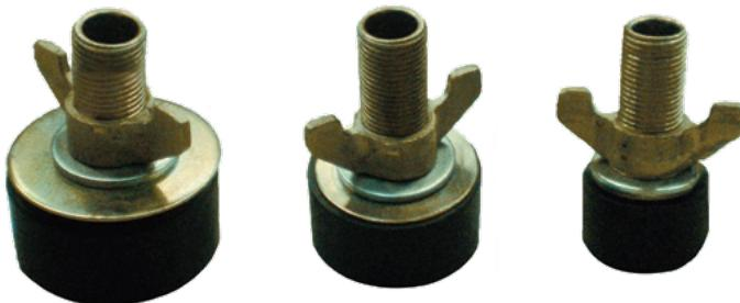
Μηχανισμός για τον γρήγορο έλεγχο πιθανών διαρροών σε PVC-U σωλήνες που ενδεχομένως έχουν υποστεί ρωγμά, καταστροφή ή κακή συγκόλληση εξαρτημάτων. Ο μηχανισμός τοποθετείται σαν τάπα μέσα στο σωλήνα. Αφού κλείσουμε όλες τις εξόδους γεμίζουμε με νερό όλο το δίκτυο και με τη βοήθεια υδραυλικής πρέσας πιέζουμε στο βαθμό της επιθυμητής πίεσης. Η ένδειξη στο μανόμετρο θα μας δείξει αν υπάρχει διαρροή.
