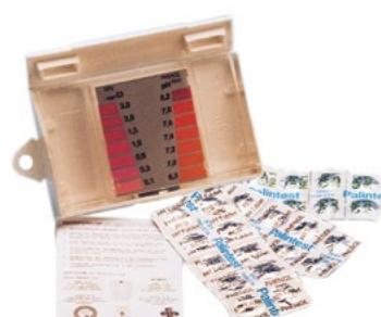
Θήκη λευκού kit με διάφανο πινακάκι ενδείξεων και δοκιμαστικούς σωλήνες μαζί με ατομικά πακεταρισμένες ταμπλέτες Cl και pH. Πίνακας ενδείξεων με διαφορετικές χρωματικές κλίμακες που παρουσιάζουν ακριβή αποτελέσματα για την κατάσταση του νερού. Μπορεί να χρησιμοποιείται επανειλημμένα. Το kit περιλαμβάνει επίσης λεπτομερή βήματα οδηγιών και συμβουλές.
